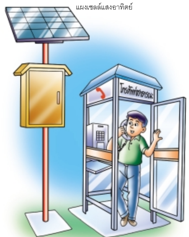
โทรศัพท์สาธารณะเคลื่อนที่ที่ใช้ไฟฟ้าจากเซลล์แสงอาทิตย์
